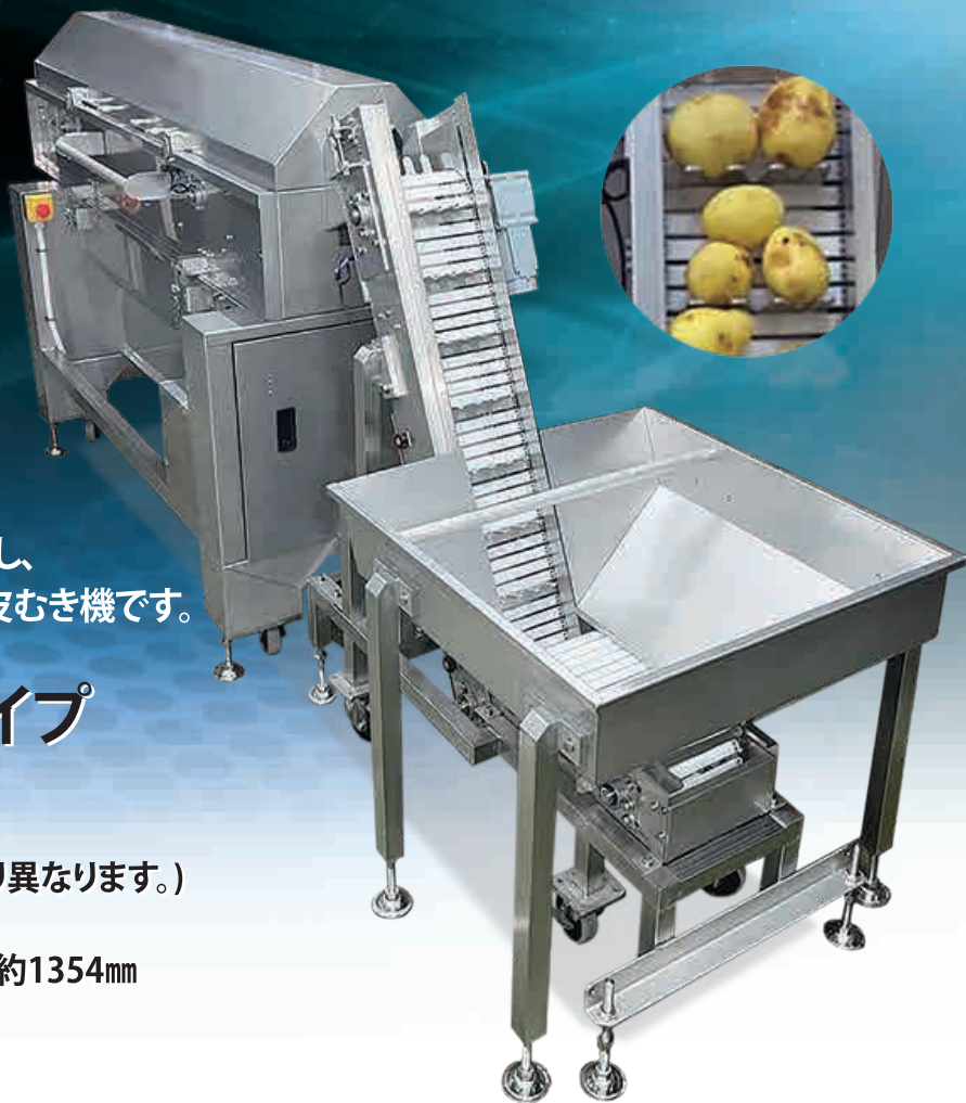
DPS-M 繰上供給機タイプ仕様 外観寸法(例)
